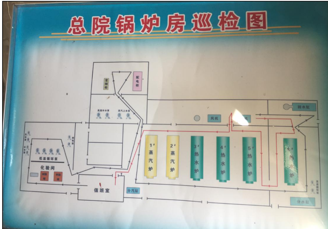
图 7-1 总医院锅炉房巡检图
